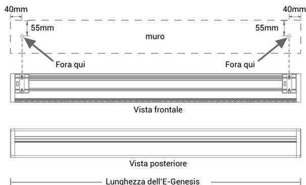
Forare sui segni di marcatura con trapano dotato di punta da 5,5mm per foratura muratura (non incluso).
